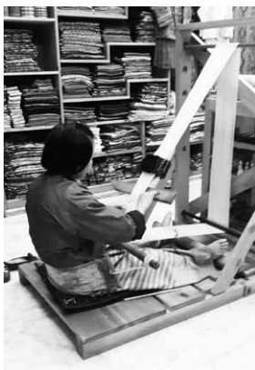
図17 カード織り 機の構造は腰機パンタに同じ。カードが綜統の役割となる。写真提供：青木薫氏
