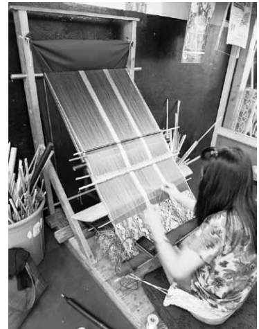
図16 腰機パンタ 経糸を機と腰で保持する。横から見ると経糸は直角三角形をなす。
